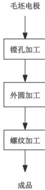
图 2.4-2 超高功率石墨电极机械加工工序工艺流程图
